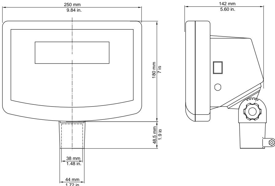
Abbildung 8-1. Gesamtabmessungen des T21P-Indikators
