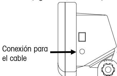
Figura 2-3. Conexión para el cable
