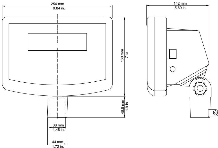
Figura 8-1. Dimensiones generales del indicador T21P.
