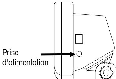
Figure 2-3. Connexion pour l'alimentation
