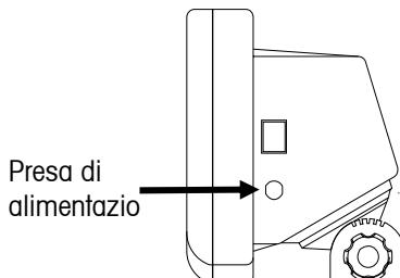
Figura 2-3. Connessione di alimentazione
