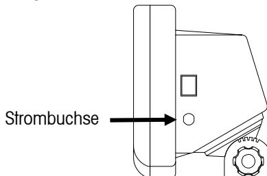
Abbildung 2-3. Stromanschluss
